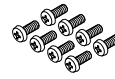
⑥ M4x12 十字穴付バインド小ねじ (ブラケット - スライドレール取付及び スライドレール - ユニット取付用) NPBA-1U27-200E 8個 NPBA-*U35-240E 16個
